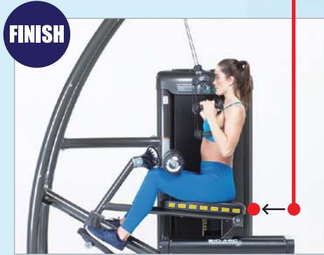
スタート時に前傾しているシートパッドは、動作に伴って後傾していく。加えてシートの前後位置も大きく前に移動することで、より広背筋に効かせやすいフォームを自然に作り出している。
